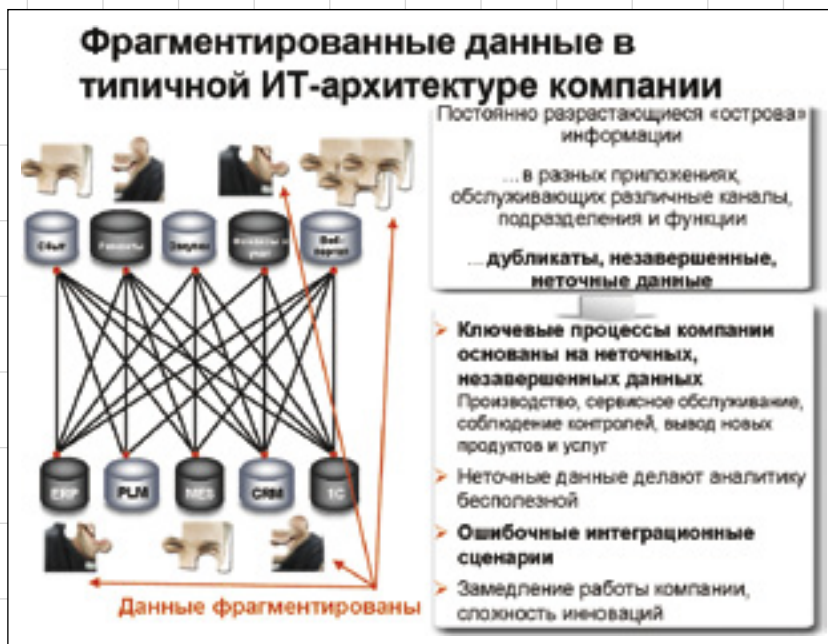
Каждая система владеет собственным источником данных. Системы интегрированы по принципу «точка-точка»
